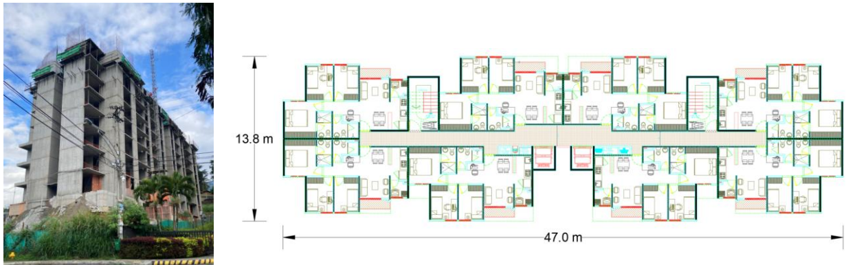
Figura 4-2. Distribución típica de TLRCW con plano de planta simétrica.
