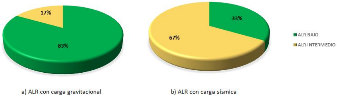
Figura 83. Clasificación ALR rediseño con a) carga gravitacional 1.2CM+1.0CV y b) carga sísmica 1.2CM+1.0CV+1E para el caso dos de estudio.
