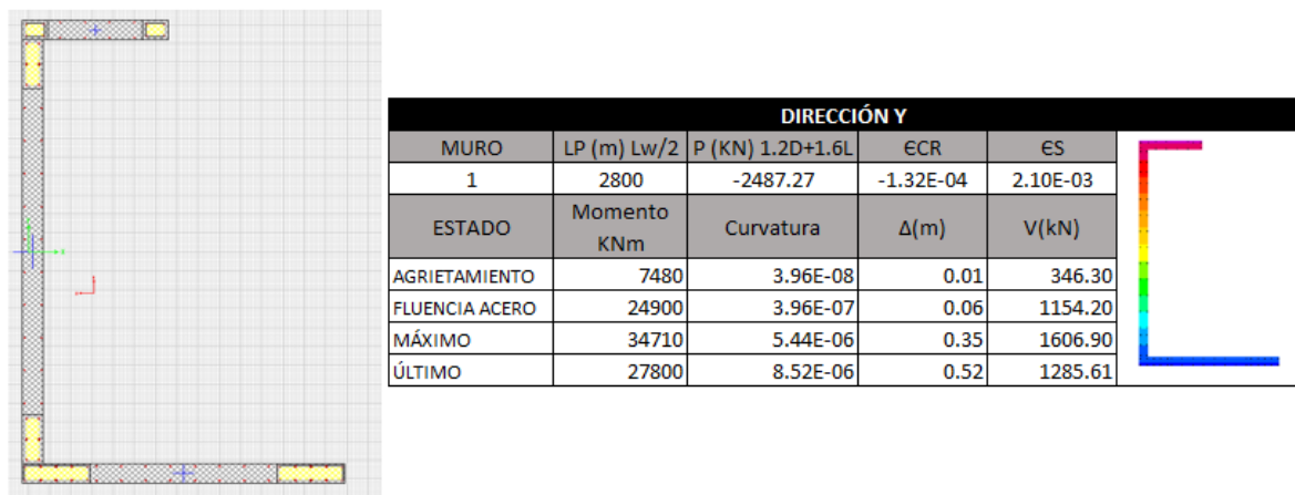
Figura 88. Momento-curvatura y curva de capacidad del muro compuesto uno, del rediseño en dirección y para el caso dos de estudio.
